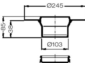
**Aufsatzelement mit Muffe**
